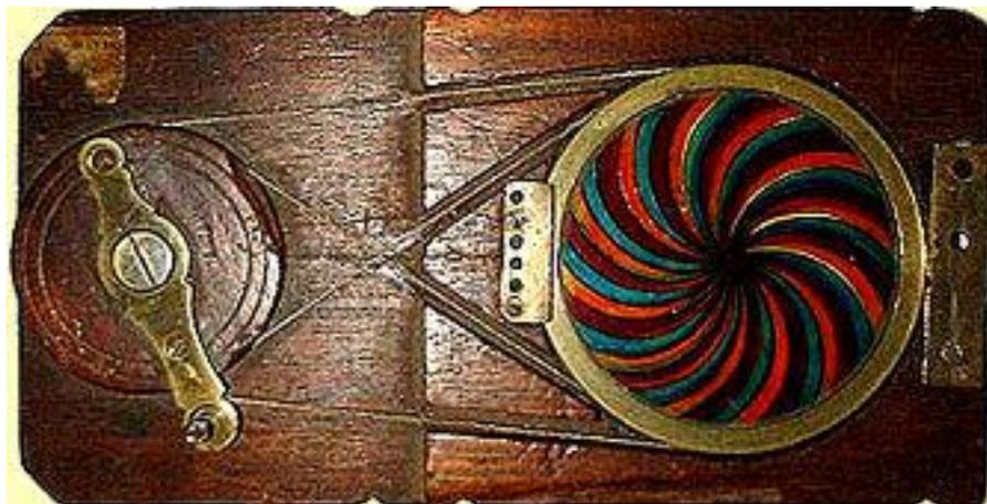
*Figure 42 : Chromatrope datant de +/- 1872. L'on aperçoit l'un des deux disques de verre coloré et les courroies dont on comprend, par leur montage, qu'ils feront tourner les deux disques superposés en sens inverse, en actionnant la manivelle.*
