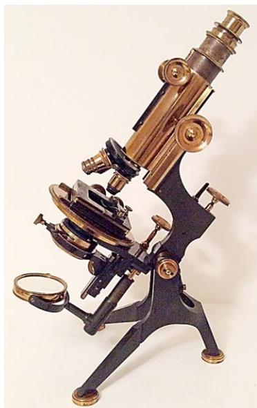
*Figure 98 : Microscope Watson-Van Heurck, modèle « Circuit Stage », le seul qui permet une rotation complète de 360° (Collection de l'auteur à Trujillo, Pérou)*
