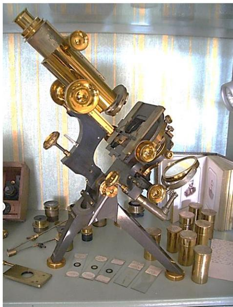
*Figure 99: Microscope « Grand Model Van Heurck » construit par la maison W. Watson & Sons à Londres à partir de 1897, le plus prestigieux, le plus perfectionné – avant la création de sa variante le « Circuit Stage » (voir figure 98, plus haut) - de ses microscopes, que le constructeur continua à produire (sur commande*
