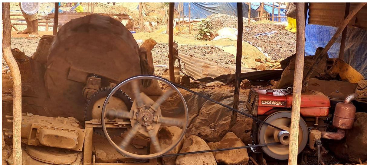
Figure 27. Un concasseur en marche. La courroie (qui est la partie la plus dangereuse) est mis en évidence
