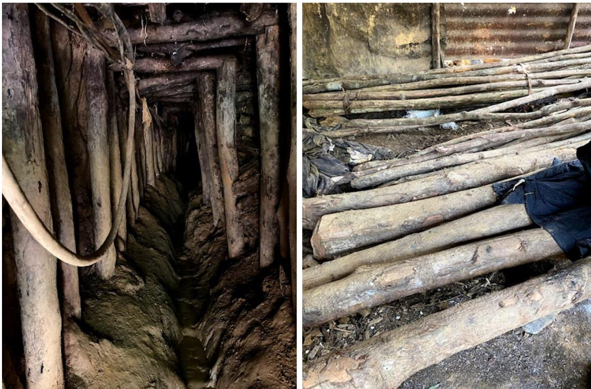
Figure 8. Puits souterrain avec constructions en bois
