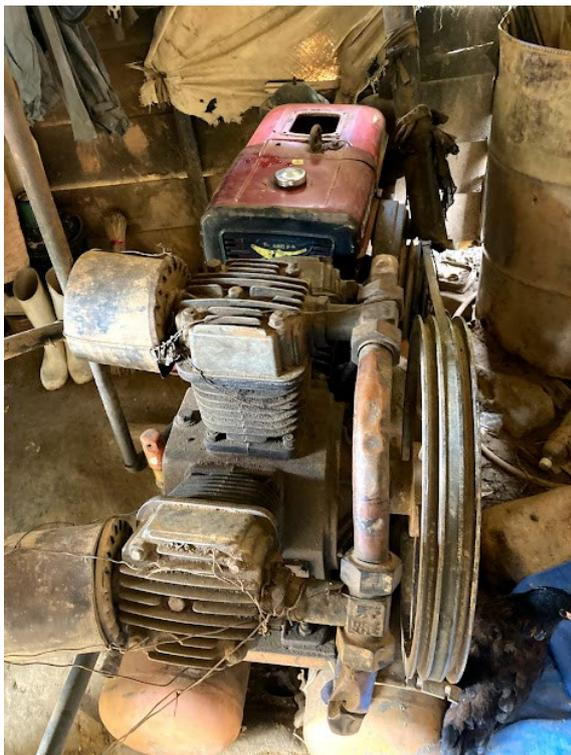
Figure 10. Compresseur d'air avec cuve
