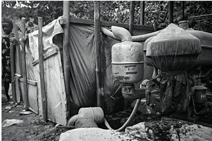
Figure 15. Changfa, échappement et réservoir d'eau ( Crédit: Carrubba)
