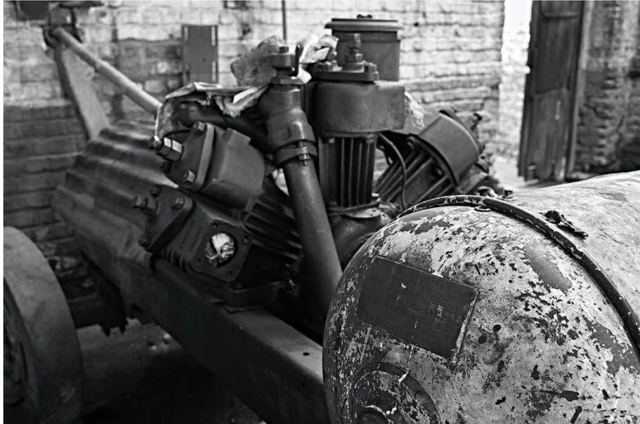
Figure 2. Compresseur d'air mobile (Atelier de SOMINKI) (Crédit: Carrubba)
