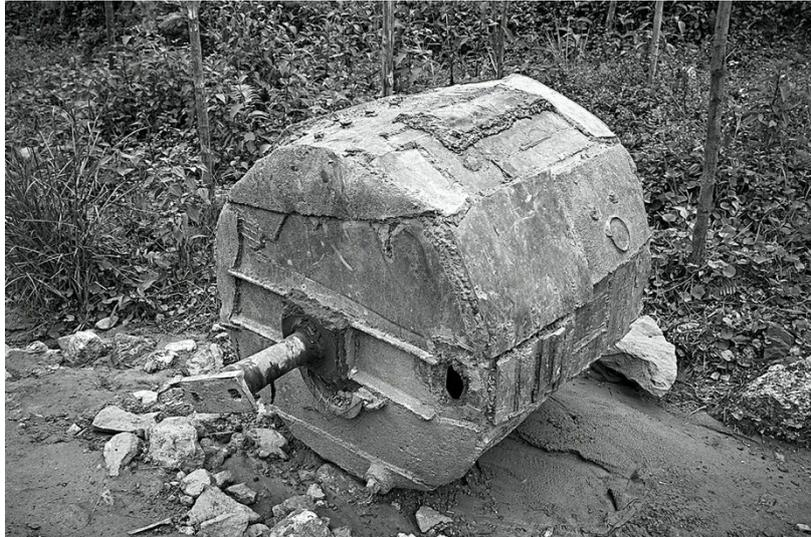
Figure 14. Concasseur soudé et réparé ( Crédit: Carrubba)
