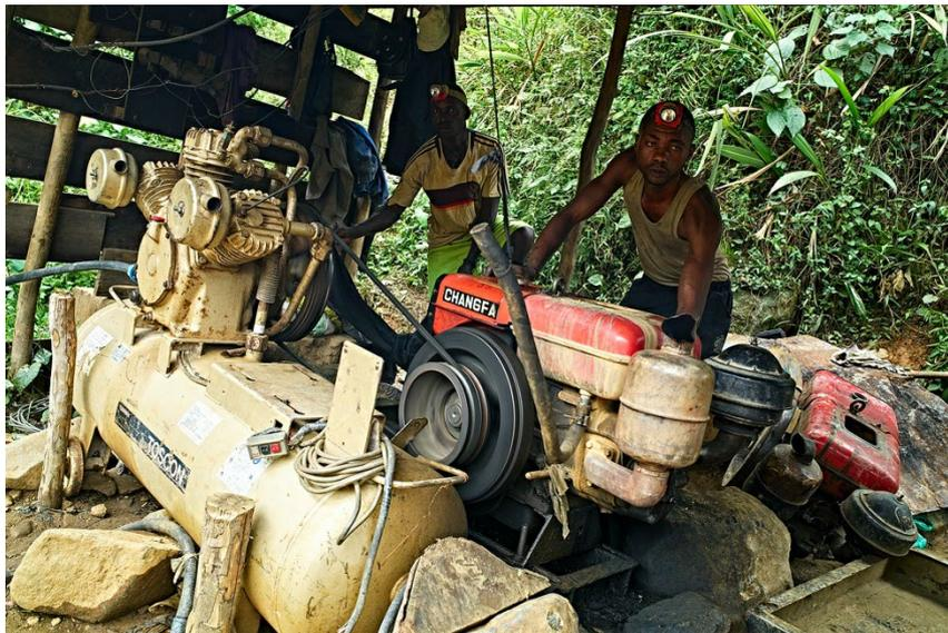
Figure 11. Compresseur d'air à deux pistons (Kiboko ya shimoke) (Crédit: Carrubba)
