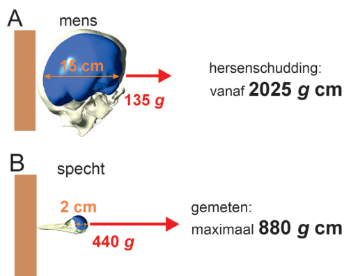
Figuur 3: Vergelijking tussen (A) de drempelwaarde voor hersenschudding bij de mens en (B) de gemeten maximumwaarde uit studie [7] (zie ook figuur 2). Hoewel de piekvertraging hoger is bij spechten (440 g vs 135 g), zal de druk als gevolg hiervan ook proportioneel zijn met de lengte van de hersenen in de slagrichting. De gecombineerde maat voor 'drukbelasting' blijft bij spechten (880 g cm) veilig onder de menselijke drempelwaarde voor hersentrauma's (2025 g cm).
