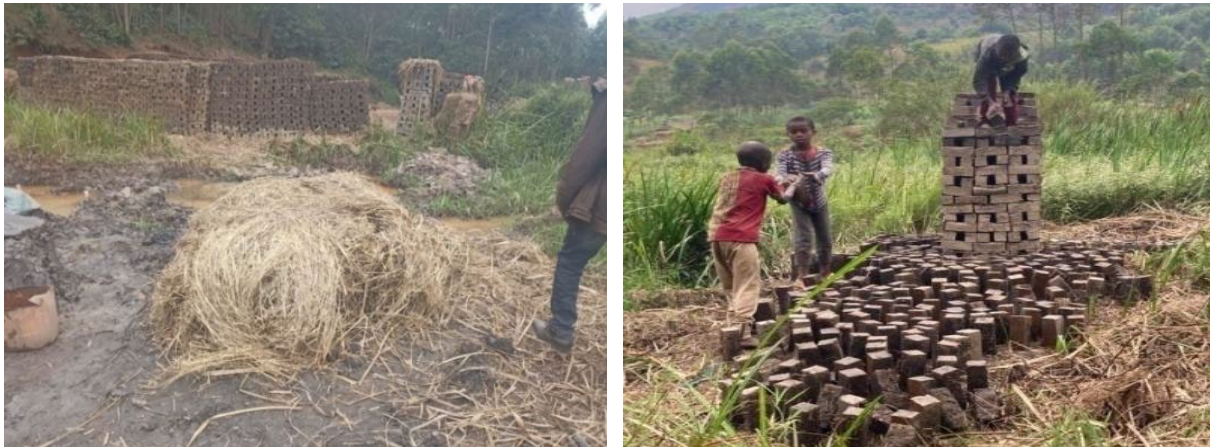
Image 4 : Paille pour couvrir les briques (à gauche) et sécheurs de briques (à droite)
