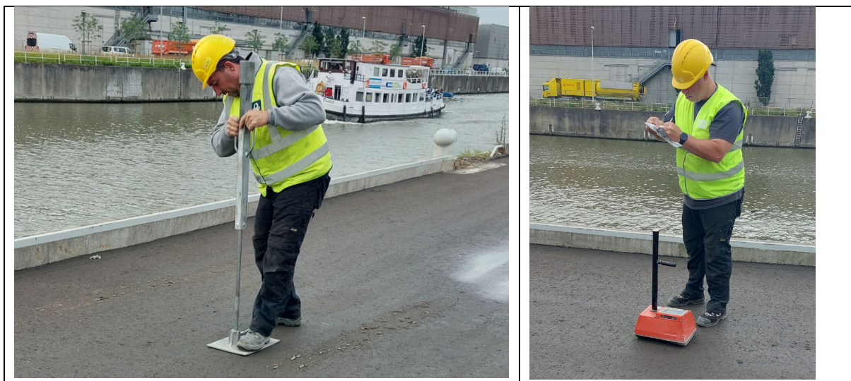
Figuur 23: foto's van inslagen pin en van meting met de nucleaire densiteitsmeter
