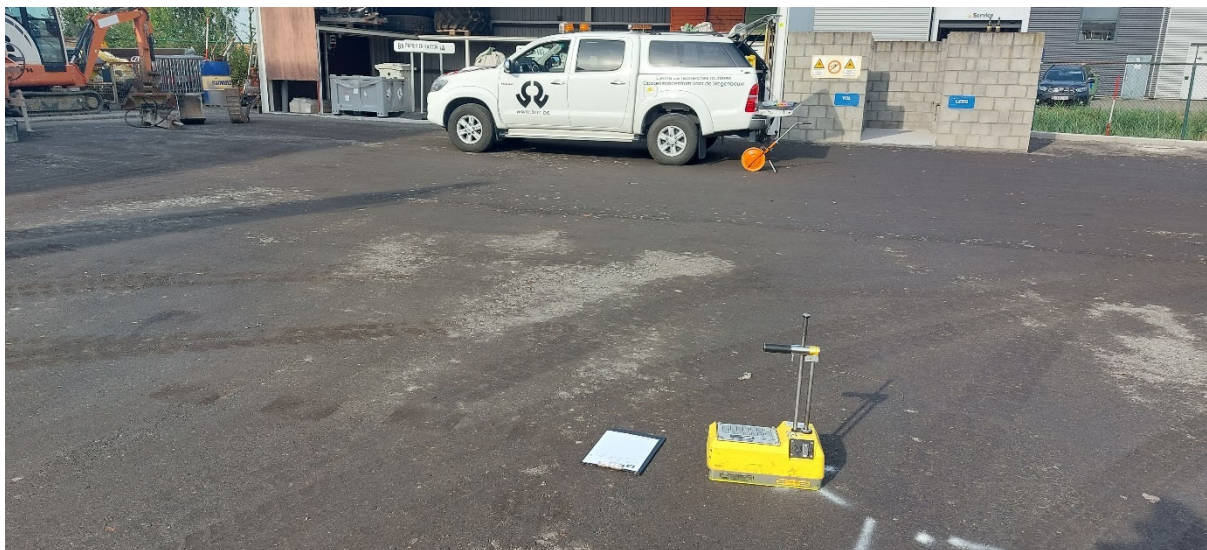
Figuur 59: foto uitvoeren nucleaire dichtheidsmetingen – proefvak 2
