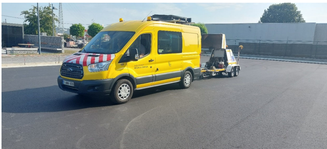
Figuur 64: foto uitvoeren valgewichtmetingen door AWV – proefvak 2
