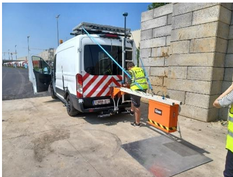
Figuur 15 - Luchtantenne (kalibratie procedure).
