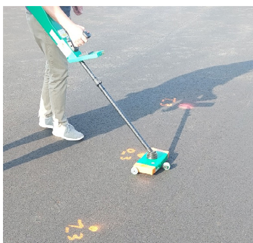
Figuur 57: foto uitvoeren laagdiktemetingen proefvak 2 met MIT-SCAN
