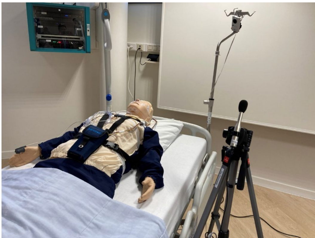
Figuur 11-1 Opstelling van de tweede geluidssensor en camera aan het hoofdeinde van het bed en een levensgrote dummy pop waarop de set-up voor een slaaponderzoek werd aangebracht
