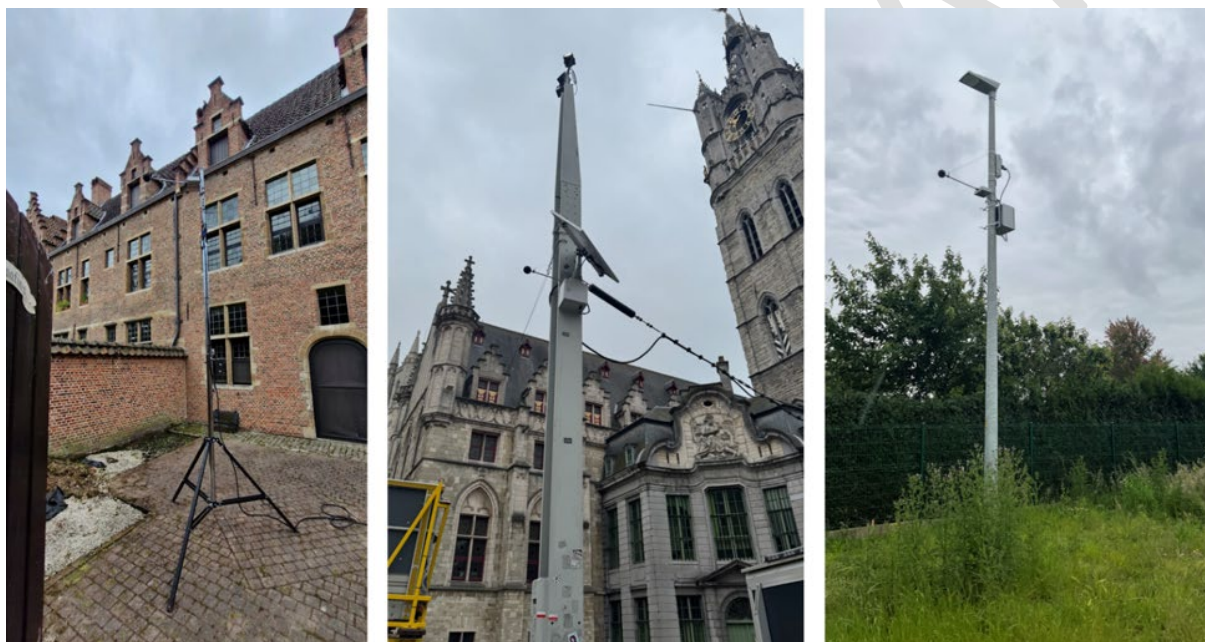
Figuur 4-1 Installatievoorbeelden van de referentiesensoren: (links) op statief, met netstroom, op het Begijnhof in Antwerpen, (midden) met zonnepaneel op de Botermarkt in Gent. (rechts) aangesloten op de stroomvoorziening van de verlichtingspaal in het Urban Sports Park in Leuven. [foto's ASAsense]
