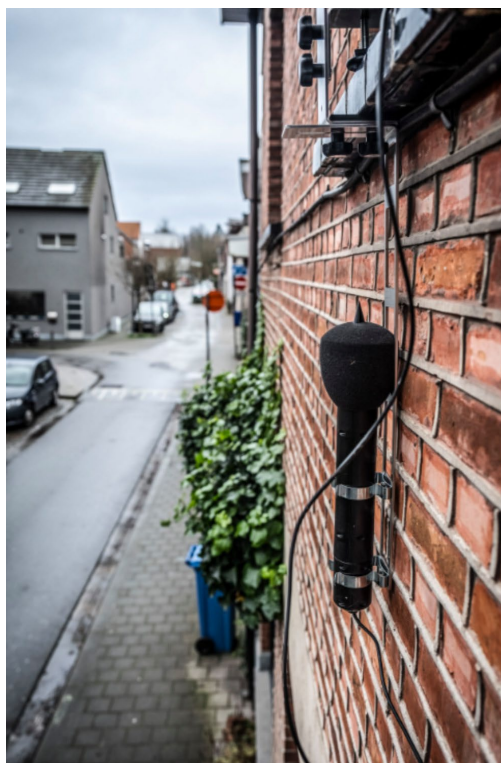
Figuur 3-3 Installatie van de slimme geluidssensoren (links) figuur handleiding en (rechts) onder een raamdorpel
